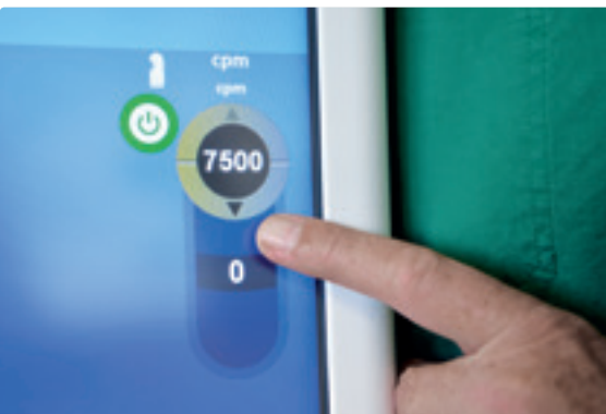
Die Schneidfrequenz wurde von 5000 „cuts per minute“ auf 7500 cpm erhöht und durch ein „Bi-Blade“-System auf 15000 cpm verdoppelt
